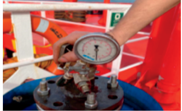
→ Yüksek çalışma basıncı, devrenin havasını alıp su geçişini sağlayan fakat önünü kapatan aparat (Kör Flenc). Test prosedürüne göre ayarlanmıştır.
